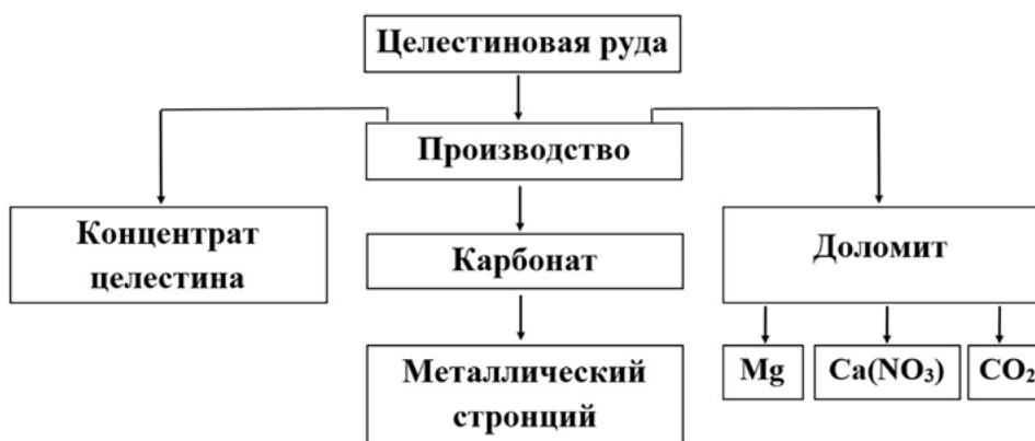
Рис.2. Схема комплексной переработки целестиновой руды
